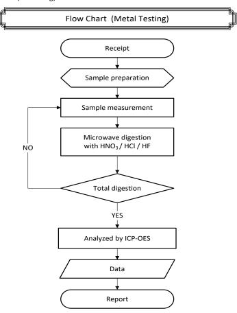
\*\* 비고 : 이 샘플은 위의 흐름도에 따른 전처리 방법에 의해 완전용해 되었음. (The samples were dissolved totally by pre-conditioning method according to above flow chart.)
