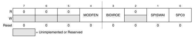
Figure 15-6. SPI Control Register 2 (SPIC2)
