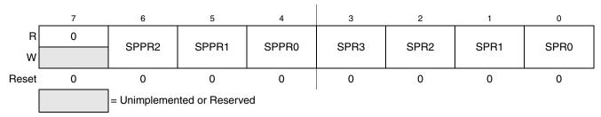
Figure 15-7. SPI Baud Rate Register (SPIBR)
