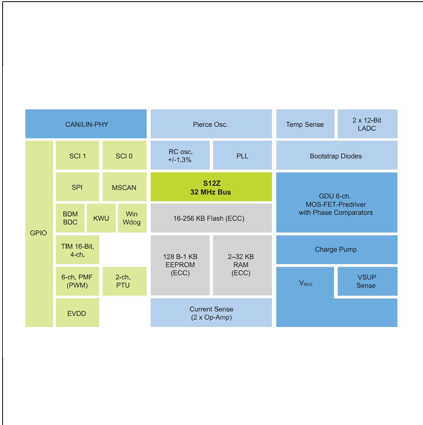
View additional information for [車載/産業用モータ制御アプリケーション向けS12ZVMミックスド・シグナル・マイクロコントローラ](#).
