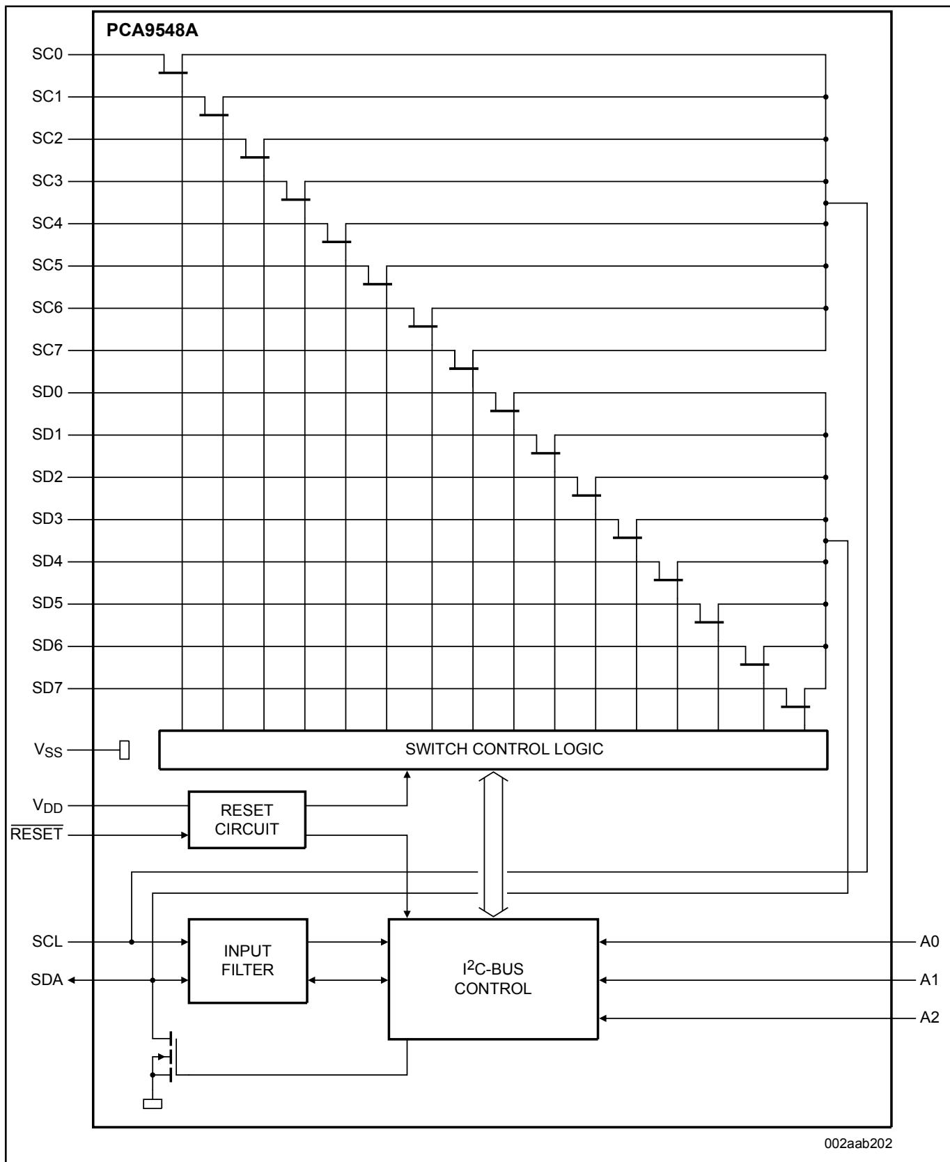
PCA9548ABS、PCA9548AD、PCA9548APW Block Diagram
