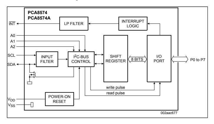
PCA8574AD, PCA8574AN, PCA8574APW, PCA8574ATS, PCA8574D, PCA8574N, PCA8574PW, PCA8574TS Block Diagram
