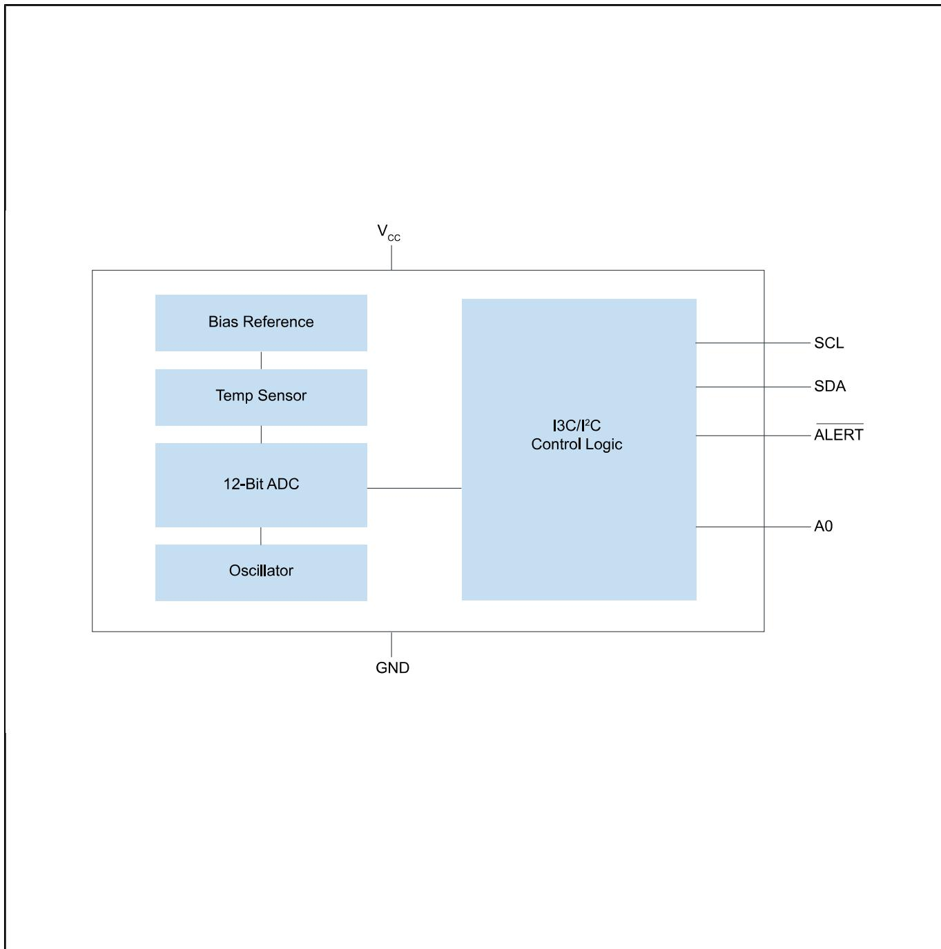
View additional information for **I3C/I<sup>2</sup>C バス対応、±0.5°C精度デジタル温度センサ**.
