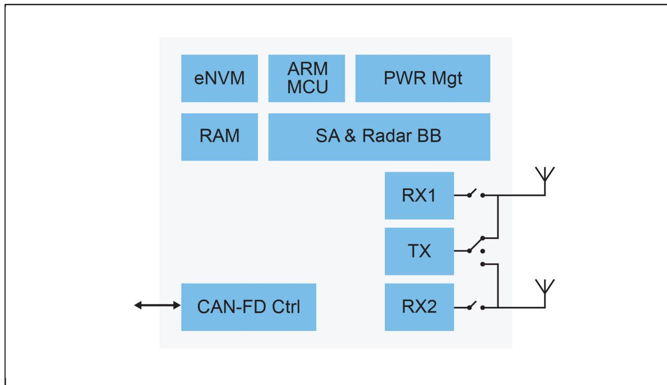
View additional information for [Trimension™ NCJ29D6 : 車載測距およびレーダー・アプリケーション用セキュアUWB IC.](#)
