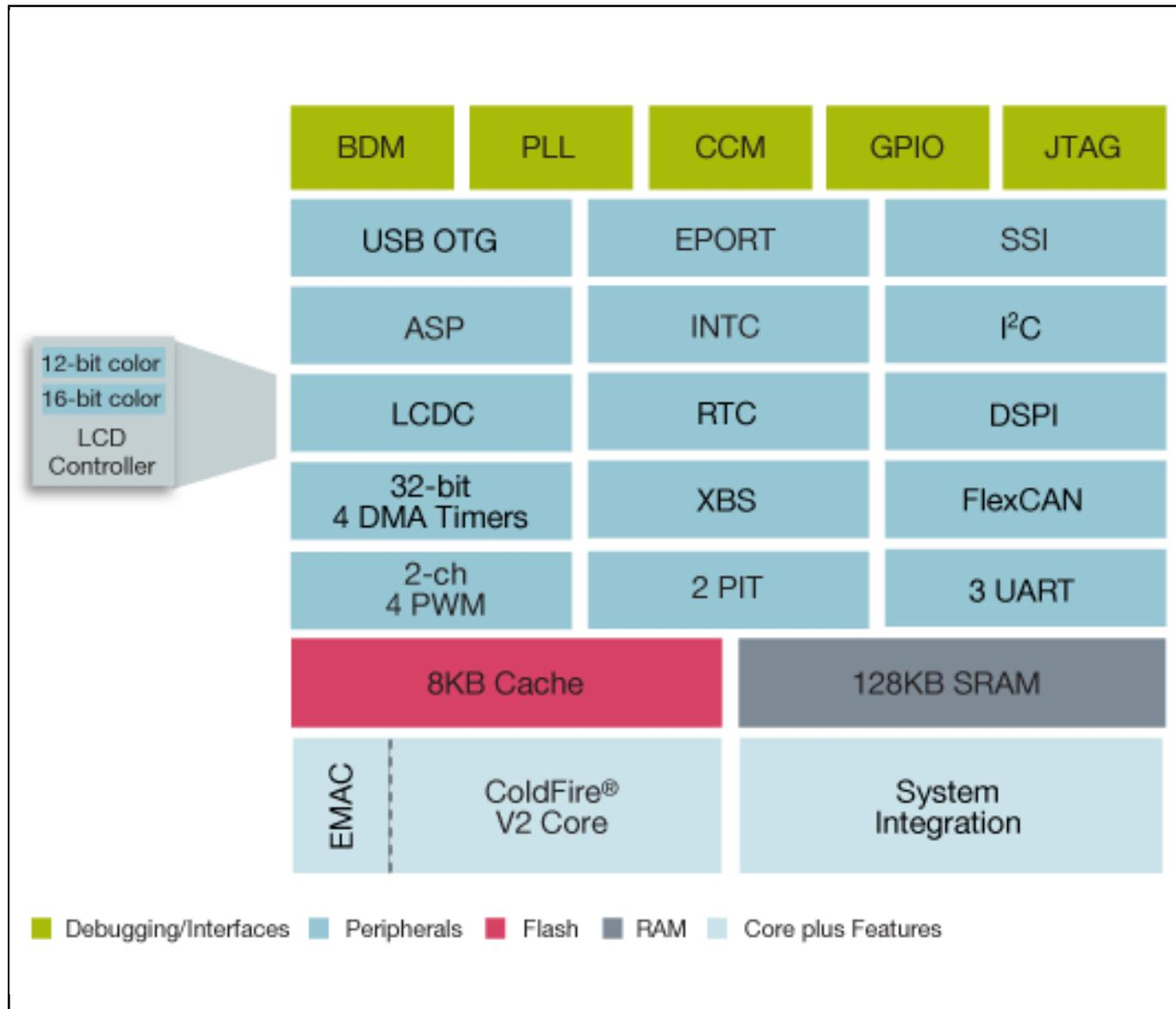
[View additional information for V2マイクロプロセッサ \(タッチスクリーン、LCDコントローラ、USB機能搭載\) .](#)
