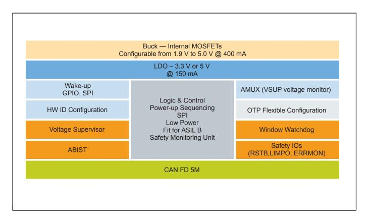
View additional information for ASIL-Bに適合した、車載アプリケーション専用セーフティ・ミニCAN FD SBC.
